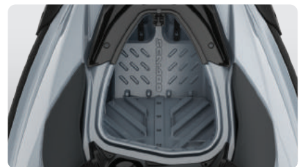
Großes vorderes Staufach Ein dicht verschließbarer Stauraum mit beeindruckenden 152 Litern ermöglicht es dem Fahrer, seine persönlichen Gegenstände während der Fahrt sicher zu verstauen.
