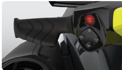
VTSM™ (Variables Trimmsystem) Mit den vom Lenker aktivierten Einstellungen lässt sich die ideale Trimmung für unterschiedliche Bedingungen leicht finden.
