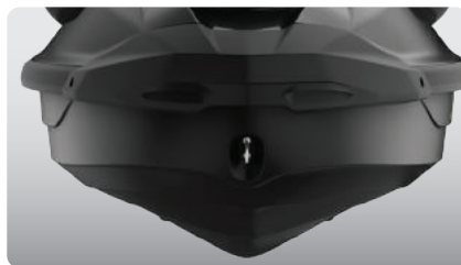
GTI-Rumpf Dieser Rumpf mit gemäßigter V-Form garantiert ein stabiles, angenehmes Fahrverhalten bei unterschiedlichen Wasserbedingungen. Souveränes, berechenbares Handling, aber unglaublich spielerisch, wenn Sie es wollen.
