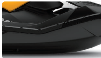
Polytec™ Innovatives Material, das für geringeres Gewicht sorgt und zugleich Leistung und Effizienz optimiert. Durch die durchgefärbte Ausführung ist es kratzfester als Glasfaser.
